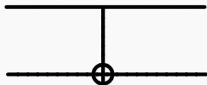
$$\begin{array}{ccc} 0,0 & \xrightarrow{\quad} & 0,0 \\ 0,1 & \xrightarrow{\quad} & 0,1 \\ 1,0 & \xrightarrow{\quad} & 1,1 \\ 1,1 & \xrightarrow{\quad} & 1,0 \end{array}$$
